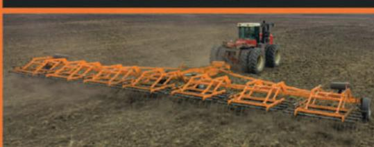
Предназначена для закрытия влаги, заделки минеральных удобрений, распределения пожнивных остатков, создания мульчирующего слоя. Борона может применяться для заделки растительных остатков, семян сорняков и падалицы с целью получения ранне-весенних всходов и их последующего уничтожения, ухода за парами. Главной особенностью нашей пружинной бороны является параллелограммная подвеска рабочих секций, обеспечивающая превосходное копирование рельефа поля
