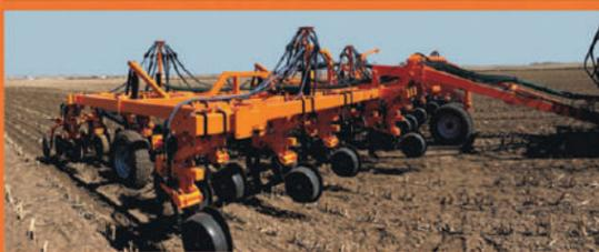
Для прямого посева, для посева по классической и минимальной технологии. Предназначен для посева зерновых и масличных культур. Независимое копирование рельефа поля каждым сошником предоставляет возможность быстрой регулировки глубины посева по всем сошникам в диапазоне от 2 до 20 см
