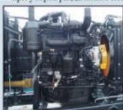
Дизельный двигатель Д-245.5 мощностью 65 кВт
