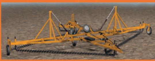
Предназначена для выравнивания поверхности поля, для рыхления верхнего слоя почвы на стерне на глубину до 50 мм, удаления сорняков, разрушения почвенной корки и создания мульчирующего слоя
